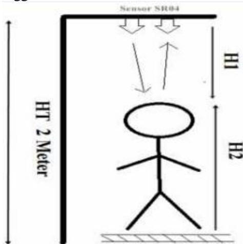
Gambar 2 Penerapan sensor ultrasonik SR04
